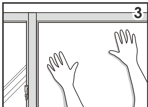
窓枠より1~2mm程内側にフィルムを貼り付けます。フィルム面にも滑りを良くする為のスプレーを行い、スクイージなどで施工液を抜き、位置決めを行います。
