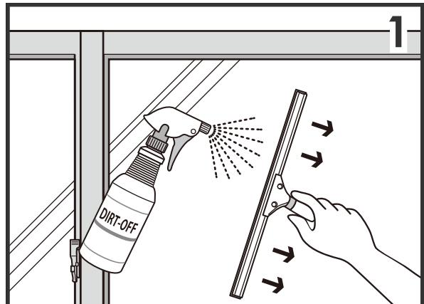
ダートオフ、または中性洗剤を水で薄めた清掃用液又は施工液をスプレーしてガラス用スクレーパー、水切りスキージ、ヘラ、ペーパータオルなどを使用して、汚れの無いように清掃してください。
