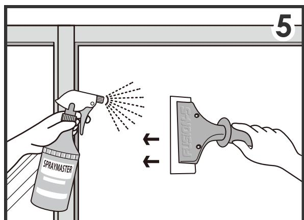
仕上げに適切な硬さのスクイージーを使い、施工液が残らないように水抜きします。エッジ部はペーパータオルを巻いたヘラなどを使用します。
