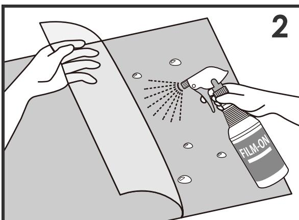
あらかじめフィルムを窓サイズに（5~20mm程度大きく）裁断します。透明の剥離フィルムを剥がし、接着剤面とガラスに施工液をたっぷりスプレーしてください。
